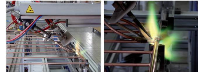
Harfen für die Absorber werden von einem modernen Lötautomaten mit Wasserstoff und Sauerstoff verlötet. Während des Produktionsprozesses überprüfen wir mehrmals die Dichtheit der Lötstellen.
